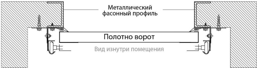
Рис - Установка ворот на проем, выполненный из пустотелых материалов. Картинки (9) (см. Фотоматериалы и иллюстрации)
